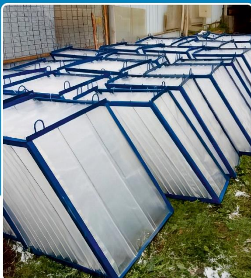
Тонкослойные модули из полиэтиленовой пленки, растянутые на металлических рамах перед размещением в сооружении
